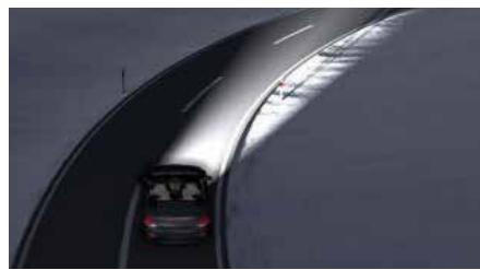
Najnoviji pametni farovi koji se prilagođavaju pogledu vozača između ostalog automatski detektuju nadolazeći saobraćaj i gase duga svjetla.
